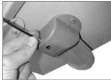
Problem a) Einstellschraube gegen den Uhrzeigersinn drehen (Erhöhung der Zugspannung)
