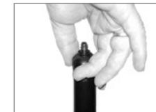
06 Gasfeder gegen den Uhrzeigersinn herausdrehen und durch eine neue ersetzen.
