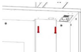
Technikcontainer bzw. Lowboard mit **Schraube F** an der Quertraverse befestigen
