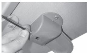
Problem a) Einstellschraube gegen den Uhrzeigersinn drehen (Erhöhung der Zugspannung) Problem b) Einstellschraube im Uhrzeigersinn drehen (Reduzierung der Zugspannung) Anschließend Kontermutter (SW8) wieder festziehen
