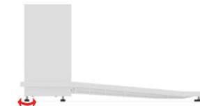
Für den Ausgleich der Bodenunebenheiten enthalten alle iMOVE Tische verstellbare Fußsteller
