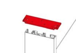
Entfernen der Säulenabdeckung nach oben
